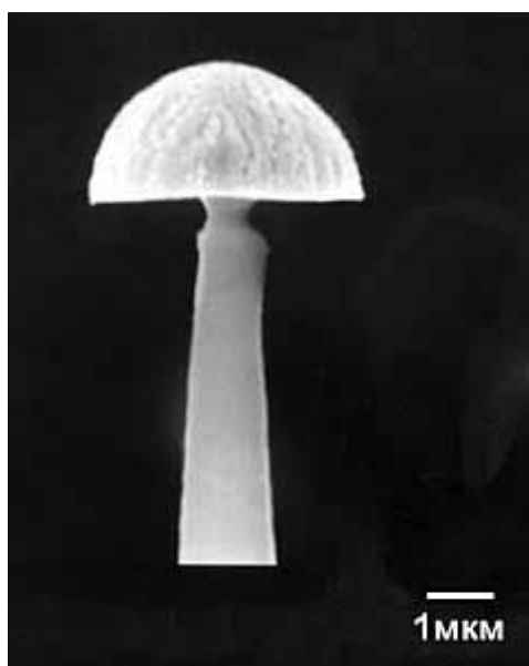
Рис. 8.15. Промежуточная стадия превращения вискера в острие [6]
