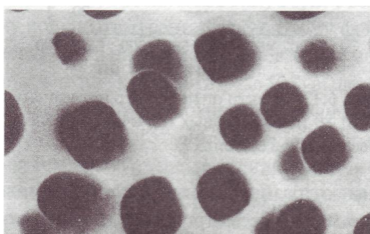
Рис. 7.32. Пористая структура кремния, полученная после травления [19]
